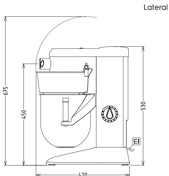
EI = Conexión eléctrica (energía)
